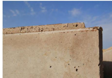
Fertigteil aus Ziegelsplitt-Leichtbeton
